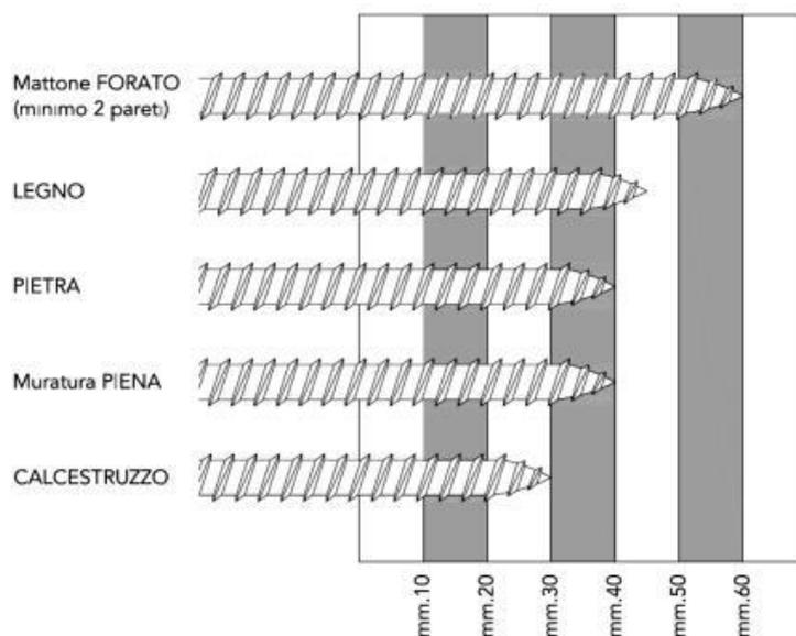
La lunghezza totale della vite, sarà individuata aggiungendo lo spessore del control telaio e dello spazio tra control telaio e muro.
