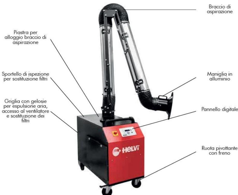
*Per evitare la loro diffusione nell'ambiente, verranno utilizzati due depuratori mobili carrellati ideali per aspirare e filtrare i fumi di saldatura da postazioni non fisse con lavorazioni saltuarie; tramite essi, i gas e i fumi che si sviluppano durante la saldatura sono aspirati in modo da evitarne la diffusione nell'ambiente di lavoro; l'aria aspirata contenente i gas e i fumi viene adeguatamente filtrata e riciclata all'interno della zona lavorativa.*
